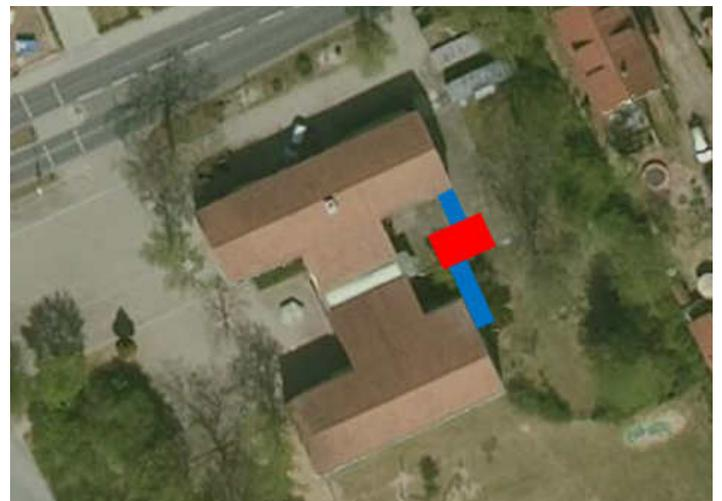
*Positionierung der außenliegenden Fluchttreppe (rot markiert), Positionierung der zwei Brücken (blau markiert); schematische Darstellung.*
