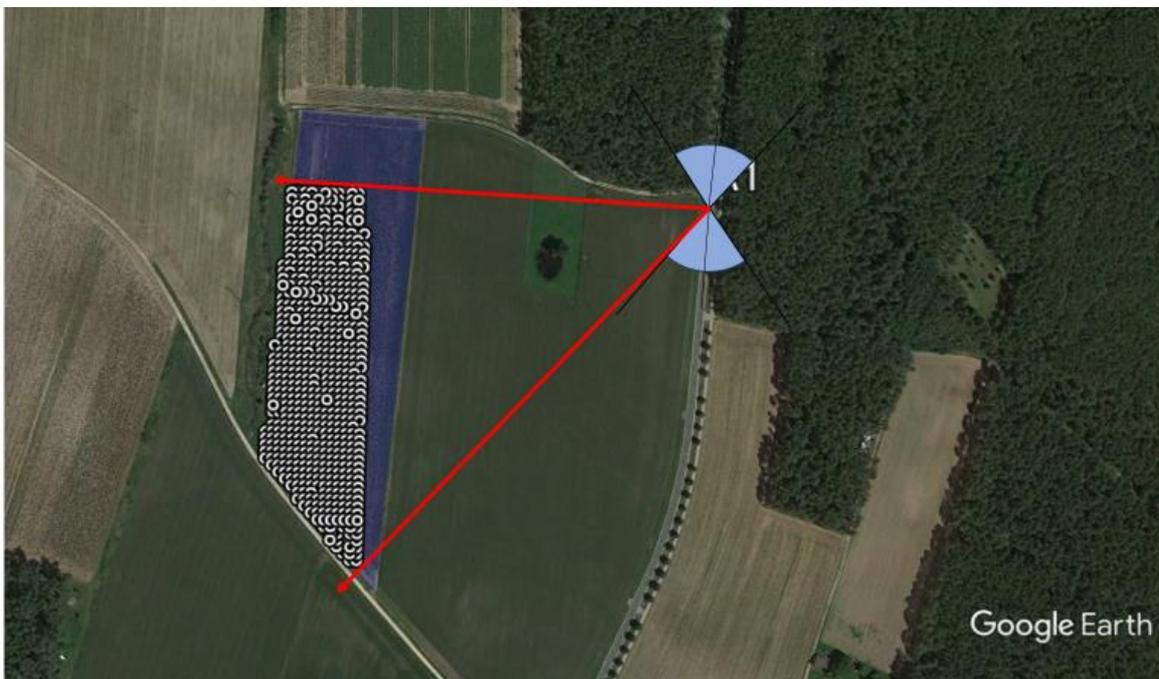
Abbildung 10: Vergleich Sichtfeld Fahrzeugführer für Punkt A1 mit Grenzvektoren in Richtung Module
