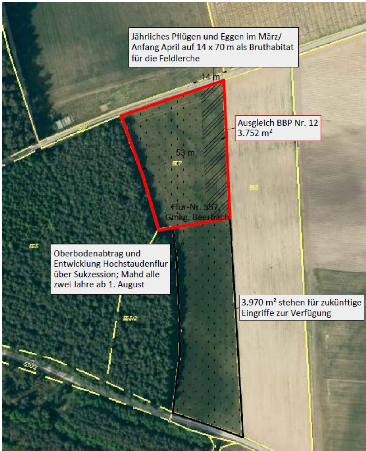
Abb. 13: Maßnahmen auf der Ausgleichsfläche Flur-Nr. 557, Gmkg. Beerbach
