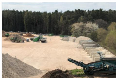
Das dort gewonnene Recycling-Material ist geeignet für Auffüllungen und den Wegebau.
