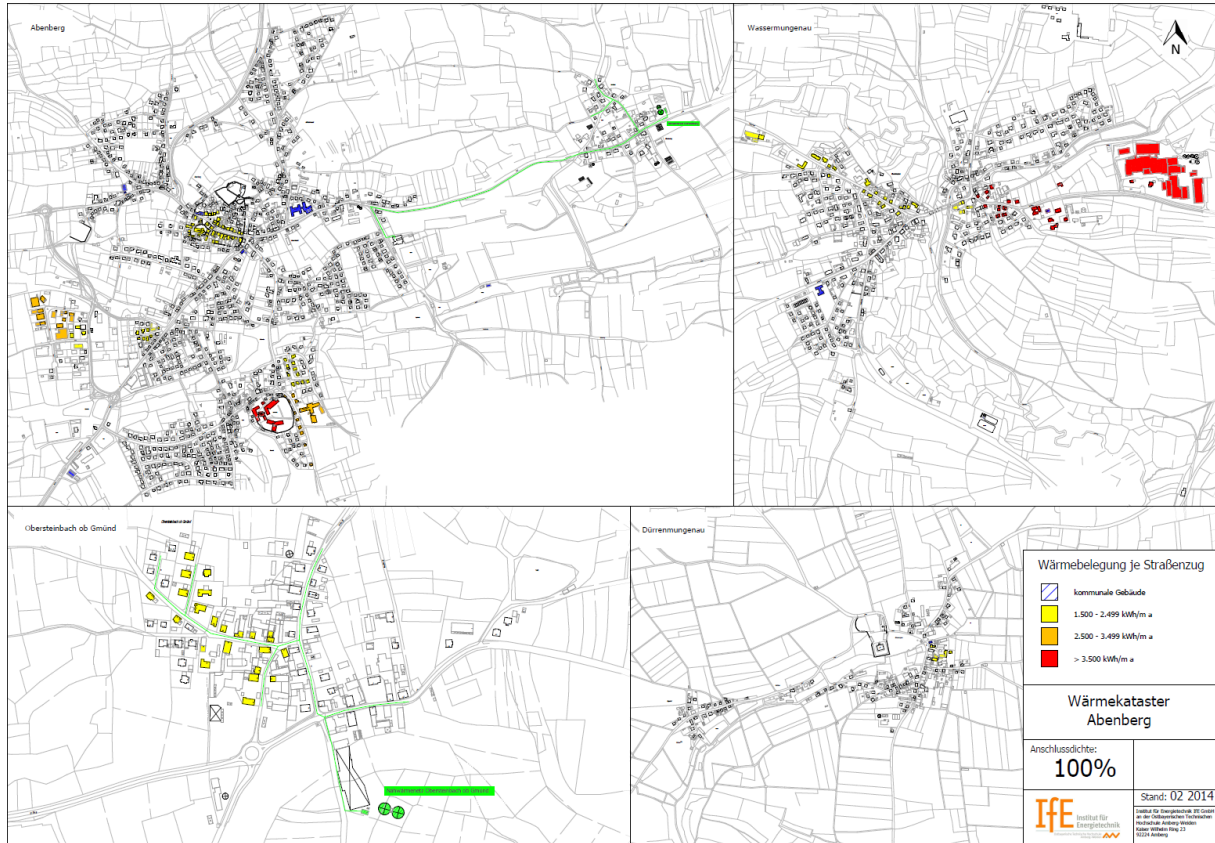
Abbildung 7: Wärmekataster der Stadt Abenberg bei einer Anschlussdichte von 100 %
