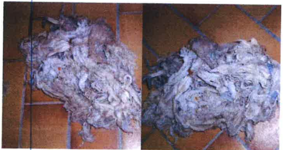
„Verzopfungen“ – ein sehr großes Ärgernis im Klärwerksbetrieb
